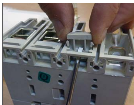
Retirer les obturateurs arrière amont.
