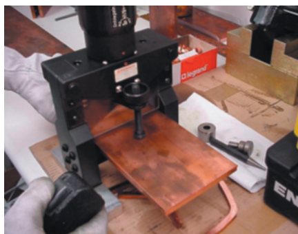
Pliage d'une barre cuivre épaisseur 10 mm sur outillage hydraulique portatif.
