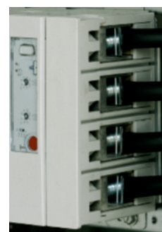
Raccordement de deux conducteurs aluminium de 185 mm 2 par pôle sur d'un DPX 3 630 avec les bornes réf. 0 261 51
