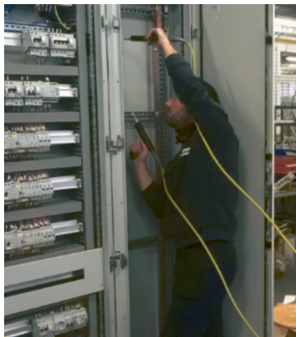
Exemple : essai diélectrique à fréquence industrielle
