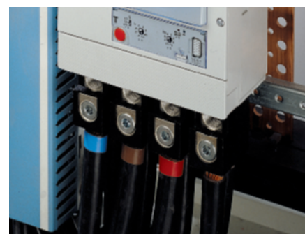
Raccordement de deux conducteurs aluminium de 185 mm 2 par pôle sur d'un DPX 3 630 avec les bornes réf. 0 261 51
