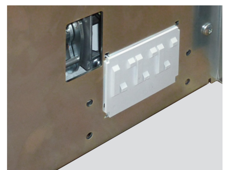
La plaque montée sous le DMX 3 actionne les contacts lors des opérations d'embrochage et de débrochage
