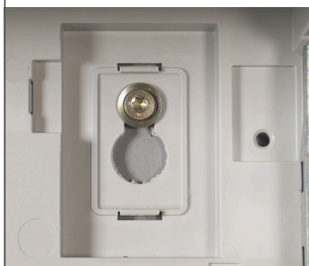
Les lumières en trou de serrure permettent l'accrochage et le décrochage des coffrets
