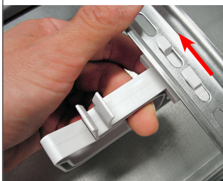
Mise en place d'un bracelet de guidage pour la circulation horizontale
