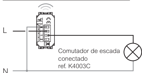
Esquema de ligação - interruptor
